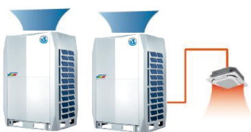
Funcionamiento normal en calefacción
