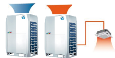
Etapa 2: Funcionamiento en modo calefacción continua
