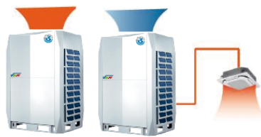
Etapa 1: Funcionamiento en modo calefacción continua
