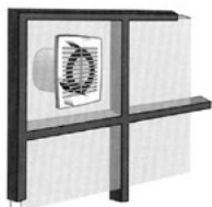
Intalación en ventana
