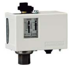
B12 CN Escala 0,2 a 8 bar Dif. 0,6 a 3 bar Código: CO18631
